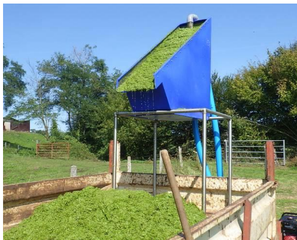
Pompage et tamisage après raclage de surface
