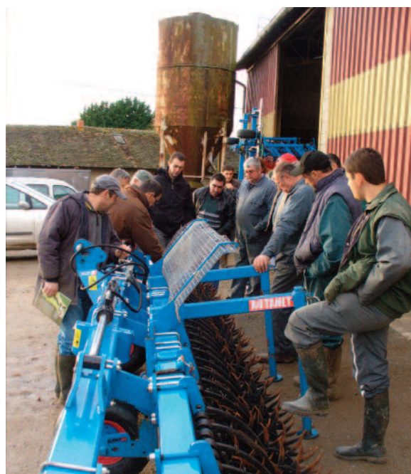
Informations aux exploitants agricoles sur le désherbage mécanique : la houe rotative
