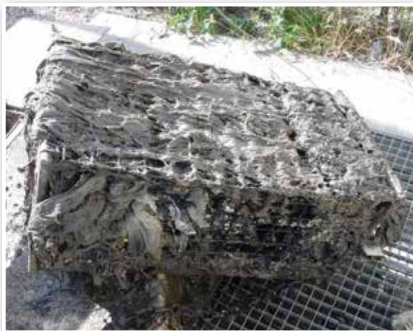
— Accumulation indésirable de lingettes sur une grille —
