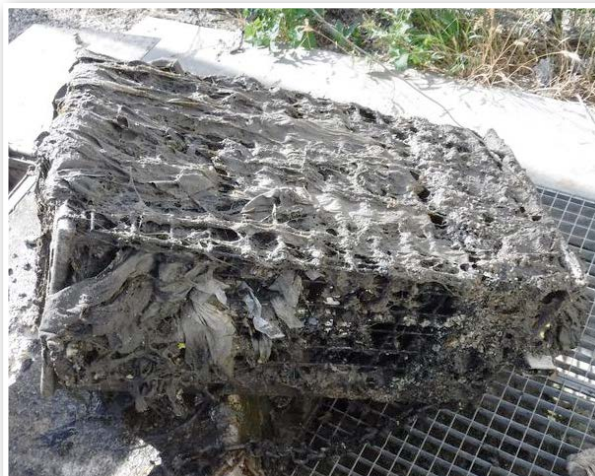
— Accumulation indésirable de lingettes sur une grille —
