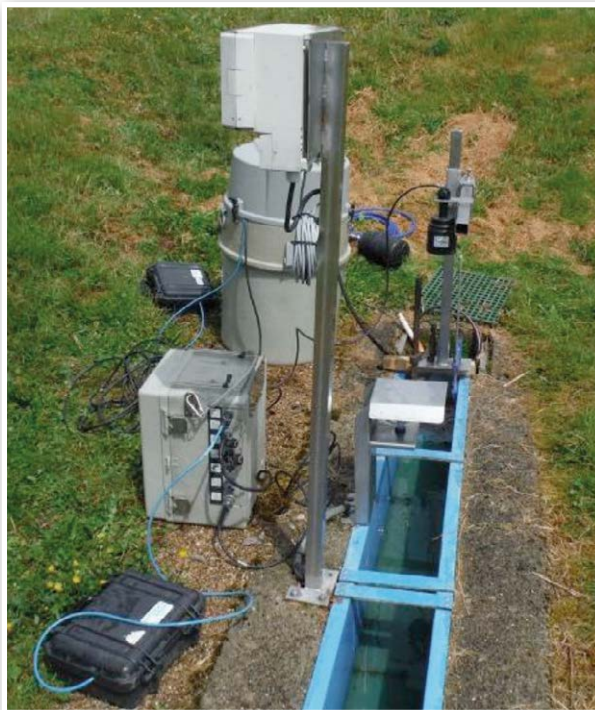
Canaux de mesure de débits en sortie de station d'épuration
